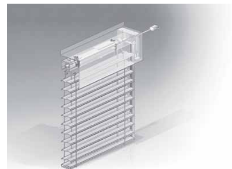
Żaluzja fasadowa z ostoną maskującą /przekrój
